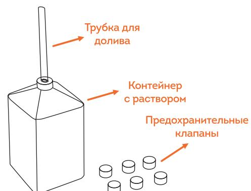
**ШАГ 4:** Мягко выдавите раствор серной кислоты из контейнера полностью. Закройте предохранительный клапан крышкой, когда наполнение будет закончено.
